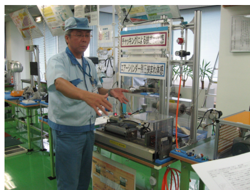
写真 - 5 (チャッキング・エアシリンダー残圧挟み込まれ体感)
