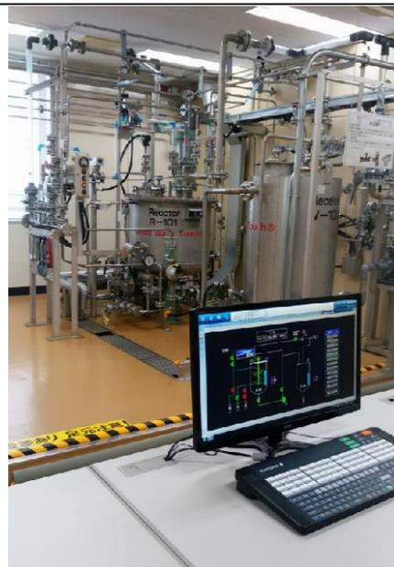
水を用いて、仕込み、昇温・冷却、移送、吸着・ろ過、蒸留工程を、コンピュータ制御で行い、プラントの基本とともに技術習得を目指す。なお、講師は、トラブルを仕掛けており、トラブルシューティングにより、現場力の養成も行っている。
