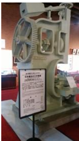
② 現存する日本最古の工作機械(堅削盤)。1857(安政 4)年、幕府がオランダから購入した 18 台の工作機械のひとつ
