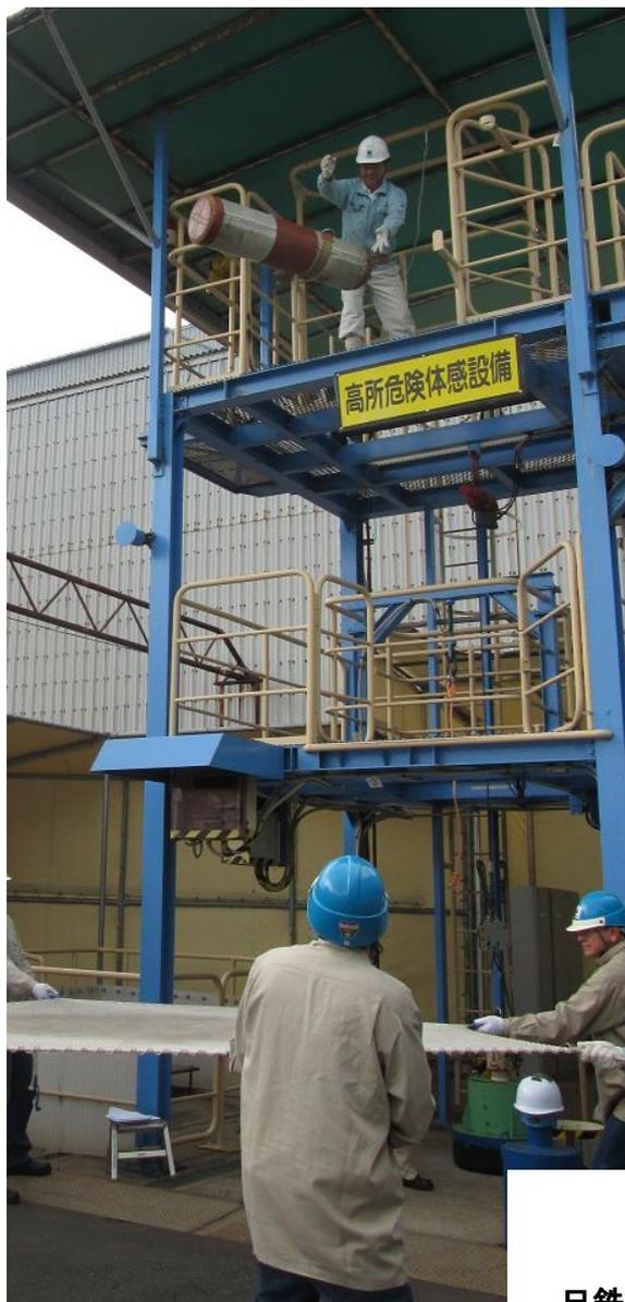
人に見立てたタックルバック (12 kg) を5 mから落下させた時の衝撃の大きさを安全ネットで受け止めて体感する
